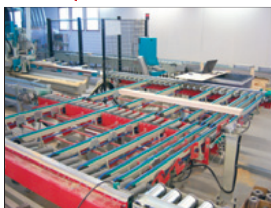
5.-6. Nach der Verzäpfungs- und Bohranlage werden die Werkstücke über eine Sortierförderanlage geführt, von der sie weiter in die Profilhobelmaschine geleitet werden. Nach der Profilhobelmaschine werden die Werkstücke zur Zwischenlagerbeförderungsanlage zusammengefasst, von wo aus sie in Wagen verladen werden.
