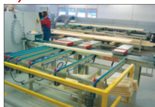
5.-6. Nach der Verzäpfungs- und Bohranlage werden die Werkstücke über eine Sortierförderanlage geführt, von der sie weiter in die Profilhobelmaschine geleitet werden. Nach der Profilhobelmaschine werden die Werkstücke zur Zwischenlagerbeförderungsanlage zusammengefasst, von wo aus sie in Wagen verladen werden.
