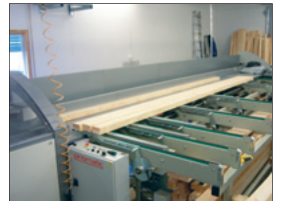
1. Am Anfang der Produktionslinie werden die geleimten Zuschnitte auf den Zuführtisch gehoben, von dem aus diese in die Kappsäge zugeteilt werden.
