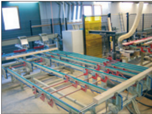
3. Zwischen dem Vierseitenhobel und der Verzäpfung gibt es eine Zwischenlagerbeförderungsanlage, die zur Aufgabe hat, die Unterschiede in der Bearbeitungszeit auszugleichen.
