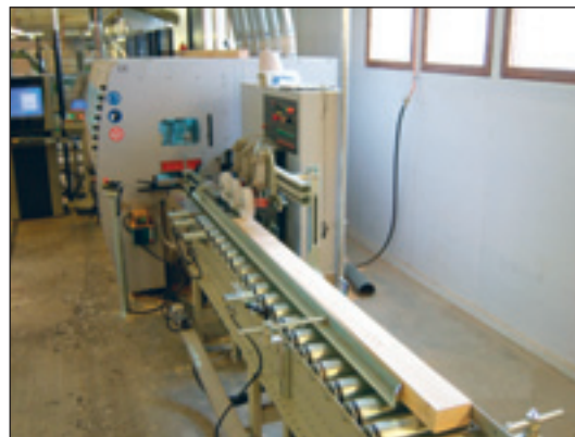
2. Die zugeschnittenen Stücke werden in den Vierseitenhobel überführt, in dem jedes Stück maßgehobelt wird.
