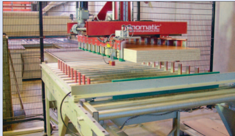
Pinomatic levypinkkari nostaa useita levyjä kerrallaan.
