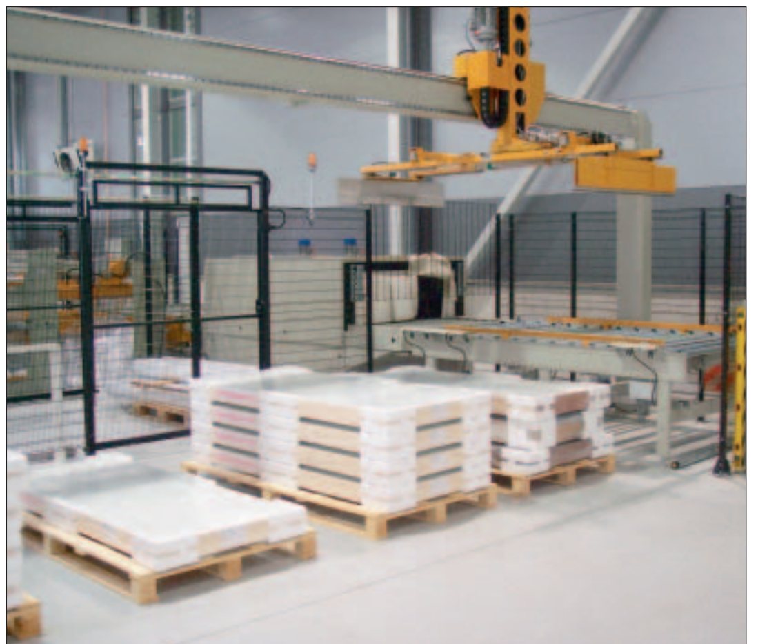
Linjan lopussa Pinomatic 2405 pinontalaite pinoaa valmiit pakkaukset tilauskohtaisille lavoille.
