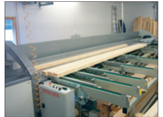
1. Liimatut aihiot nostetaan syöttöpöydälle, josta ne annostellaan katkaisusahalle.
