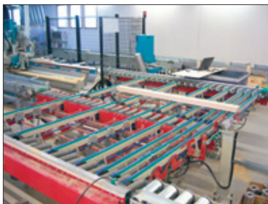
5.-6. Tapituksen ja porakoneistuksen jälkeen kappaleet ohjautuvat koontakuljettimelle, josta ne siirtyvät profilihöyläykseen. Profilihöyläyksen jälkeen kappaleet kerääntyvät välivarastokuljettimelle, josta ne ladotaan vaunuihin.
