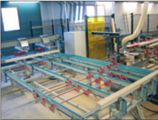
3. Höylän ja tapituksen välissä on välivarastokuljettimet, joiden tehtävänä on tasata työaikaeroja.
