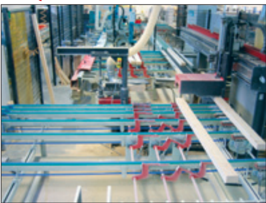
4. Seuraavassa vaiheessa kappaleet siirtyvät tapituskoneelle, jonka jälkeen ne ohjautuvat joko porakoneelle tai ohituskuljettimella ohi porakoneen
