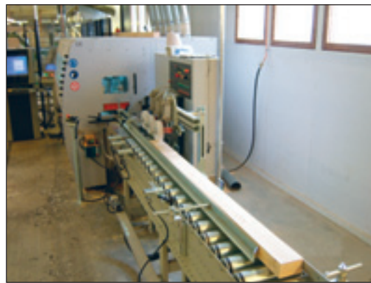
2. Katkotut kappaleet siirtyvät nelisivuhöylään, jossa kappale mitallistetaan.
